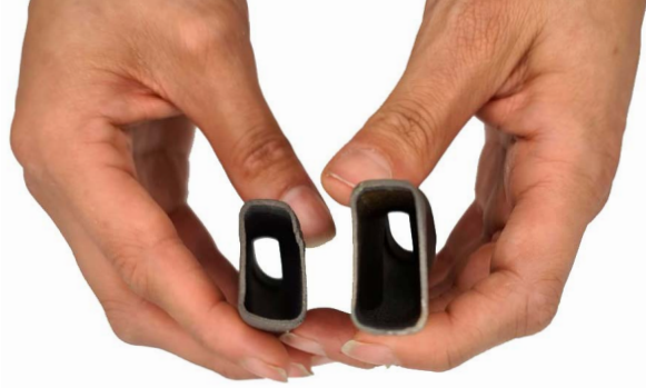
Confronto tra un componente del foderò saldato a mano e uno prodotto in 3D
